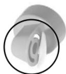
Enclencher la membrane sur la valve jusqu'à ce que la membrane repose bien à plat.
